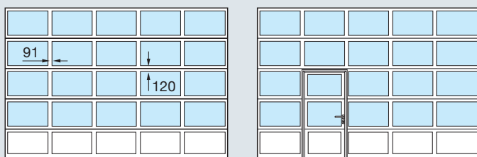
U vrat od šířky 5510 mm sériově s profilem příčky 91 mm, na přání obdržíte i vrata do šířky 5500 mm s profilem příčky 91 mm
