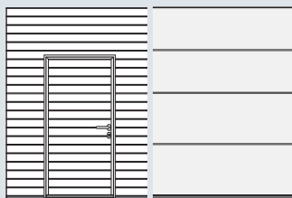
Vrata s integrovanými dveřmi bez vysokého prahu jsou k dodání až do šířky 7000 mm.
