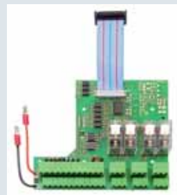
E FU H / R FU X Rozšiřovací deska pro řízení: BK 150 FUE H (E FU H) AS 500 FU E (R FU X)
